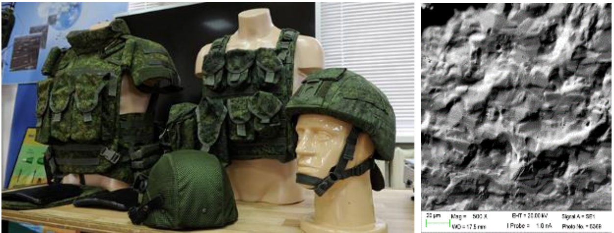
Бронежилеты и защитные шлемы из керамики на основе карбида бора (слева) и микроструктура спекаемых изделий (справа).
